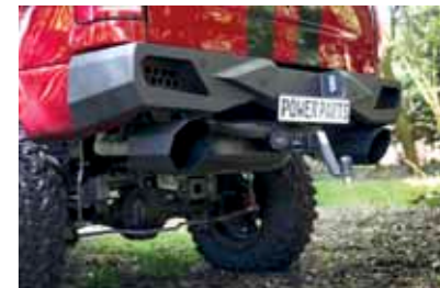
Achtkantig rausgebrüllt: Die Edelstahl-Auspuffanlage mit ihren ungewöhnlichen Endrohren sorgt für "extrem kräftigen" V8-Sound.
