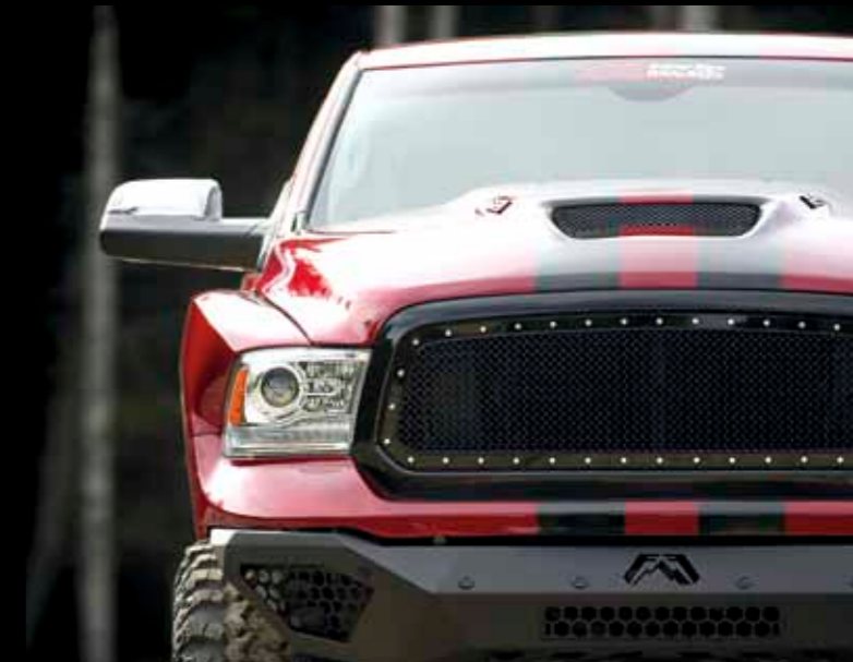
Durch einen Gittergrill des Herstellers D-One wurde das Serienteil ersetzt, eine GFK-Haube mit Hutze leitet zusätzliche Luft an das Cold Air Intake.
