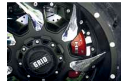
Chromeinsätze an den mattschwarzen GRID-Rädern ziehen die Blicke auf sich, die Bremsanlage wurde mit geschlitzten Scheiben und Karbonkeramikbelägen optimiert.
