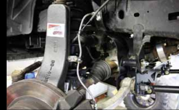
Speziell für das XXL-Extreme Höherlegungskit werden die Radträger gefertigt, Stahlflexleitungen verbessern die Bremsanlage.
