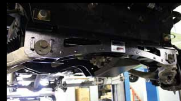
Ebenfalls Teil des XXL-9"-Höherlegungs pakets ist der für Power Parts auf Maß gefertigte Querträger.
