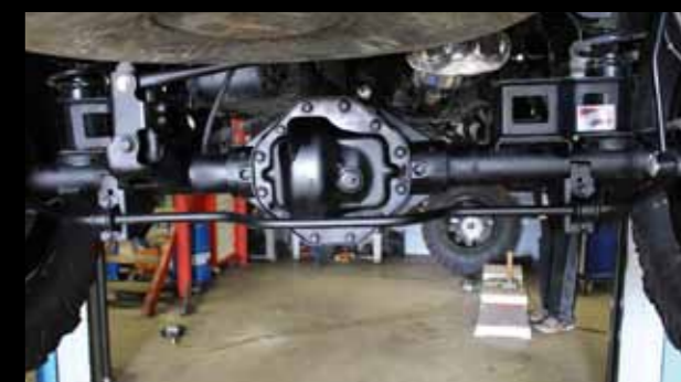
Für 23cm mehr Luft zwischen Achsen und Chassis sorgt das XXL-Kit, weitere 9cm Bodenfreiheit gehen auf das Konto der Bereifung.
